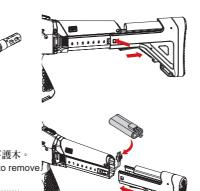
注意 重新組裝時,必須依反向動做組合 電池的拆裝方法 Battery Installation and Disassembly
