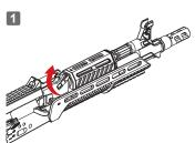
將上護木環固定鈕向上扳起。 Flip up the upper handguard fixing lever.
